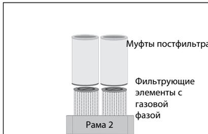
2. Рама 2 включает четыре фильтрующих элемента с газовой фазой и четыре муфты постфильтра. Удалите раму 2 с картриджами.
